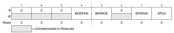
Figure 15-6. SPI Control Register 2 (SPIC2)
