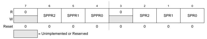
Figure 15-7. SPI Baud Rate Register (SPIBR)
